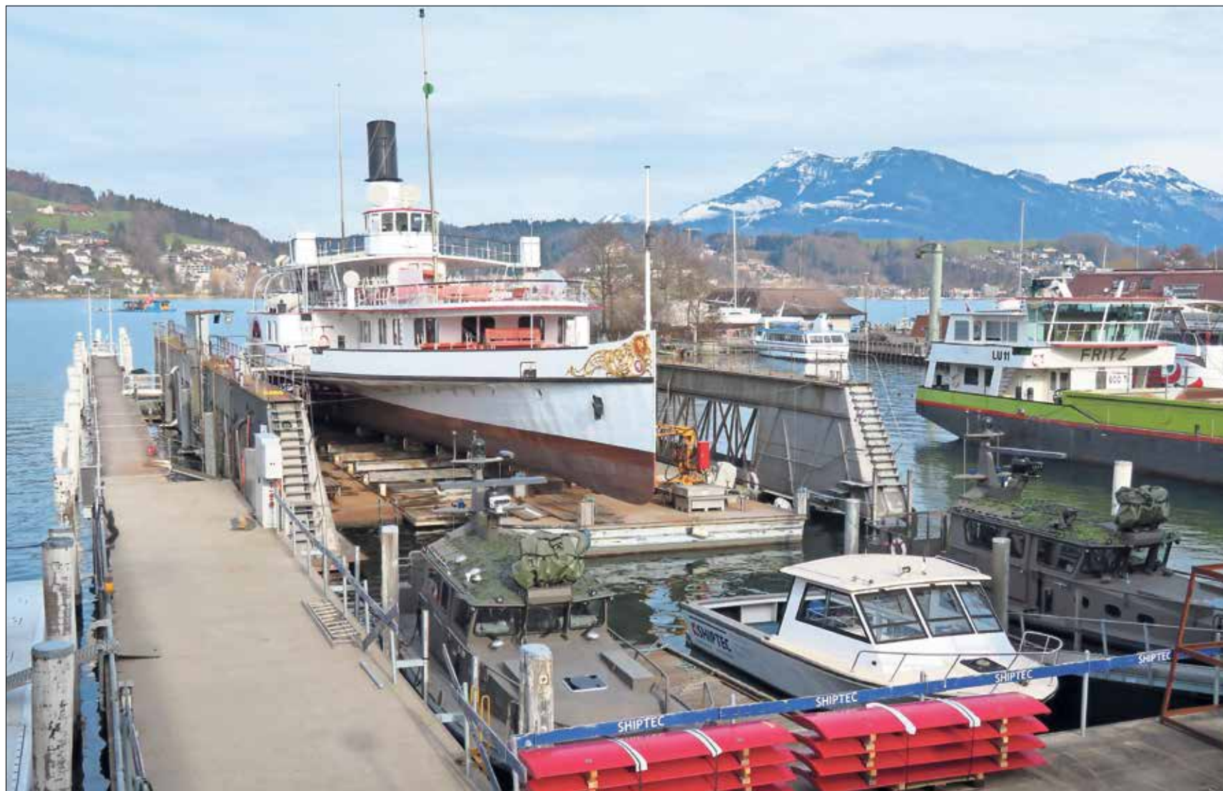
Ein interessanter Blick aufs Werftgelände mit dem Dampfschiff Gallia auf dem Schwimmdock.
